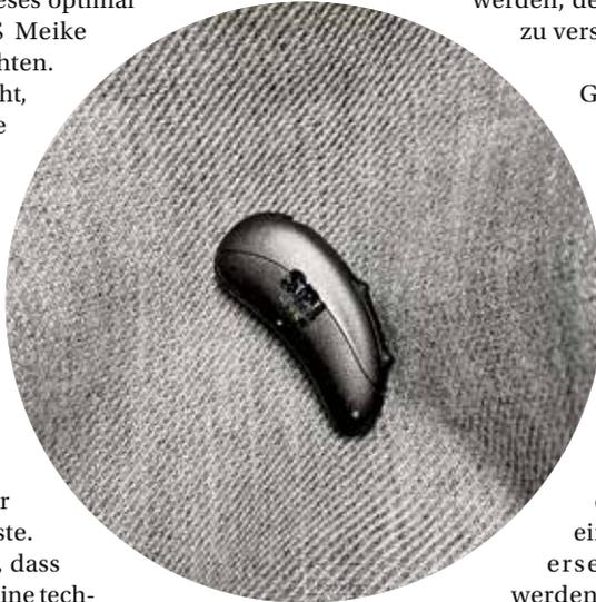
Genau dort setzt IAS an. Der „Individual Akustik Sensor“ ist ein kleiner Pin am Revers, der die verschiedenen Hörsituationen registriert, die der Träger erlebt und speichert diese ab. So wird die subjektive Einschätzung des Bedarfs durch eine objektive Messung ersetzt. Wohlgedenkt werden nicht die Gespräche belauscht, sondern nur die akustischen Rahmenbedingungen aus der Perspektive eines Hörgerätes analysiert und aufgezeichnet.
