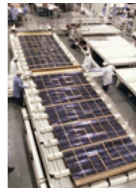
Inspektion eines Solar Blankets
